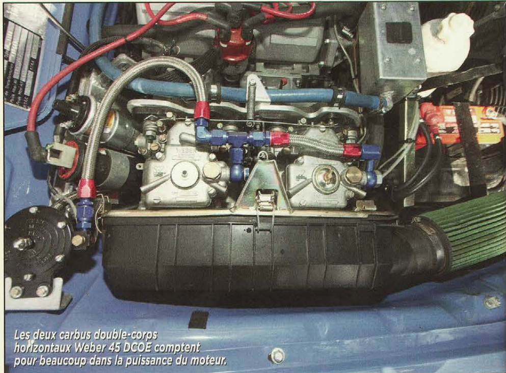
La cartouche filtrante est déportée du moteur pour une meilleure accessibilité, sur un support qui accueille également la sonde de pression.
