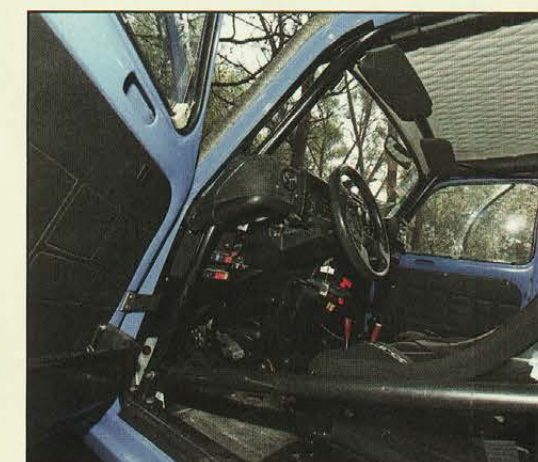
L'arceau fabriqué sur mesure est là pour la rigidité mais aussi pour la sécurité des occupants.
