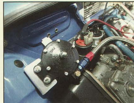
Le circuit d'essence a droit à un régulateur de pression.
