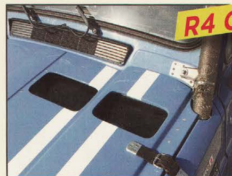
Deux prises d'air ont été aménagées dans le capot pour extraire la chaleur du moteur.
