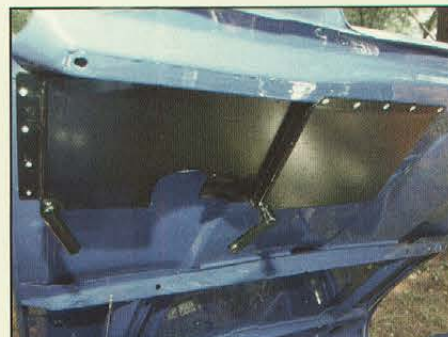
Les deux prises d'air du capot sont calissonnées afin d'empêcher l'eau d'entrer.
