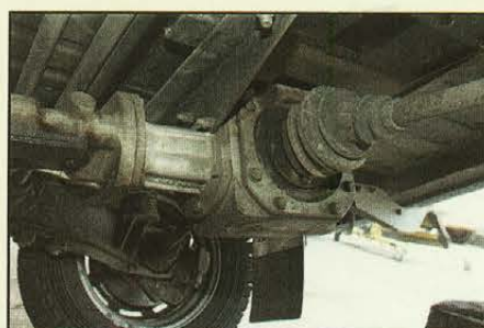
Le pont Sinpar ne posa pas de problème en course, c'est le couple conique qui a lâché.
