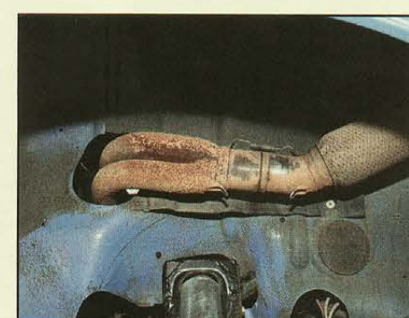
L'échappement 4 en 2 en 1 sort par le passage de roue avant gauche, comme à l'origine.
