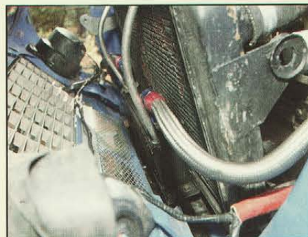
Un radiateur d'huile douze rangées est disposé devant le radiateur d'eau.
