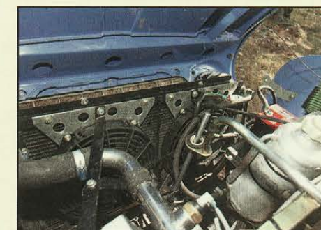
Le gros radiateur de R5 Alpine est refroidi par deux ventilateurs électriques Spal.
