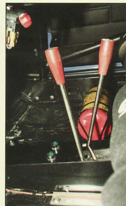
Les leviers de crabotage de la transmission Sinpar sont bien là. Il s'agit de la dernière évolution de cette transmission.
