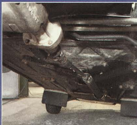
Comme l'arbre de transmission sort sur le côté de la boîte, il est muni d'un cardan pour le remettre en face du pont.
