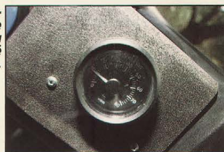
Le petit compte-tours prend place à gauche du combiné d'instruments.
