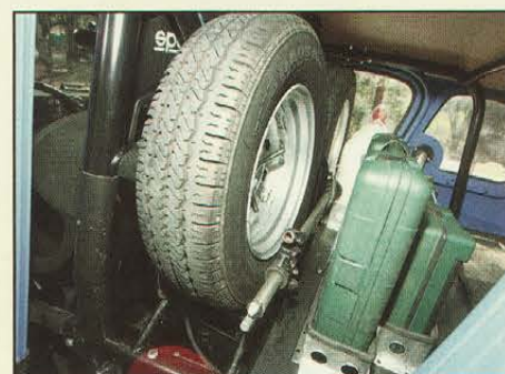
Les deux roues de secours sont situées derrière les passagers, sur le treillis tubulaire. On aperçoit également le cric.
