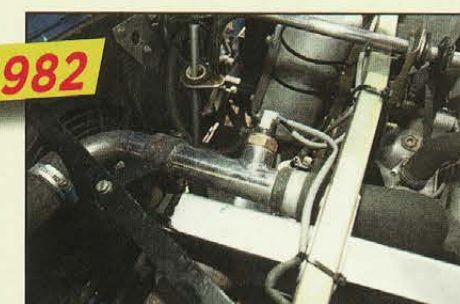
La sonde de température d'eau est vissée en sortie de culasse, sur la durite en inox.
