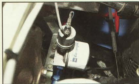
La cartouche filtrante est déportée du moteur pour une meilleure accessibilité, sur un support qui accueille également la sonde de pression.
