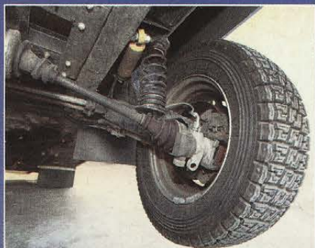
On distingue ici le cardan de transmission arrière, l'amortisseur de Clio Groupe A et le ressort supplémentaire monté sur des supports spéciaux et qui durcissent encore la suspension.
