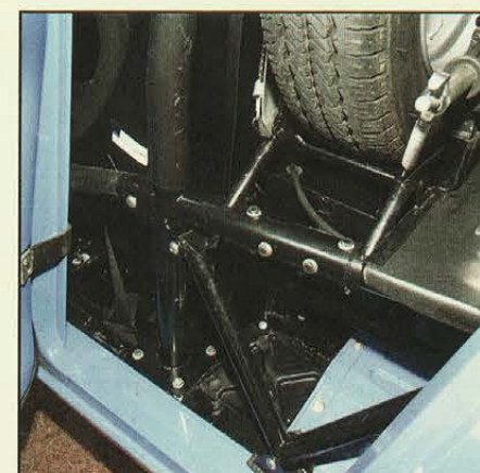
A l'arrière, nous avons un véritable treillis tubulaire.
