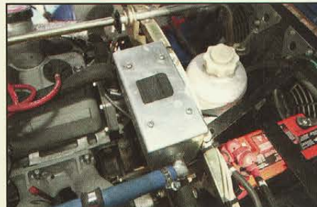
Nous avons là une boîte de reniflard, qui recueille les vapeurs d'huile produites par le fonctionnement du moteur. Puis l'huile qui se condense retourne dans le carter.
