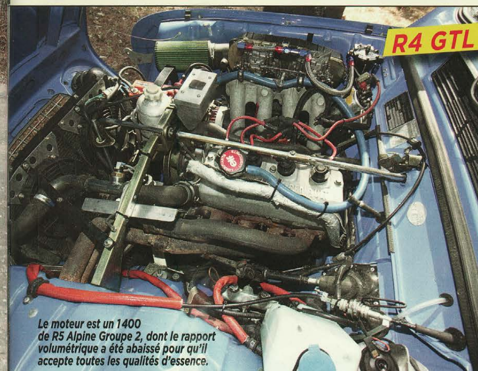
La sonde de température d'eau est vissée en sortie de culasse, sur la durite en inox.
