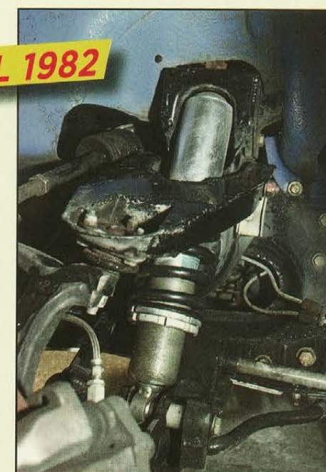
A l'avant, les amortisseurs sont remplacés par des combinés ressort-amortisseur réglables en hauteur et tarés sur mesure.
