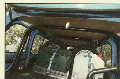
Vue sur l'arceau ainsi que la goulotte de remplissage d'essence.
