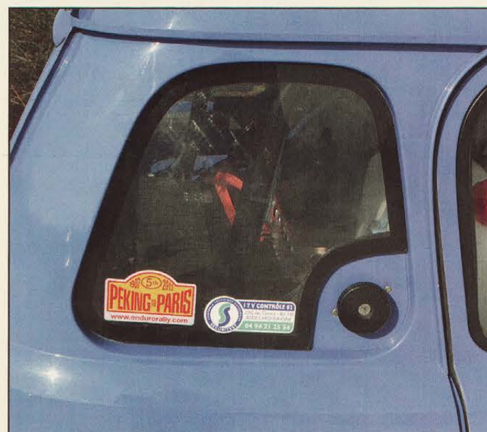
Le remplissage du réservoir type aviation de 100 litres s'effectue désormais par la vitre de custode.
