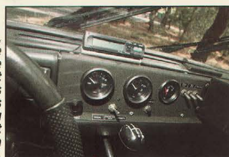
Manomètre d'huile, jauge de température d'eau, jauge à essence Jaeger et divers interrupteurs (dont un pour les ventilateurs du moteur) composent le centre de la planche de bord.
