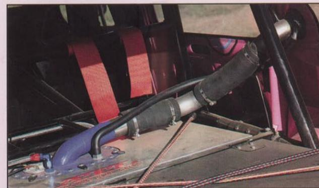
Le conduit de remplissage du réservoir "aviation" avec sa prise d'air. La durit qui part pour alimenter le carburateur est elle aussi de type aéronautique.
