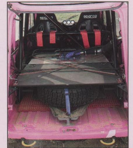
Dans le prolongement du réservoir de 80 l, la planche porte-bagages. La seconde roue de secours est logée en dessous.
