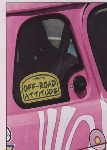
Les vitres de custode ont cédé la place à des plaques de matériau synthétique transparent. La trappe de remplissage du réservoir a naturellement trouvé sa place.
