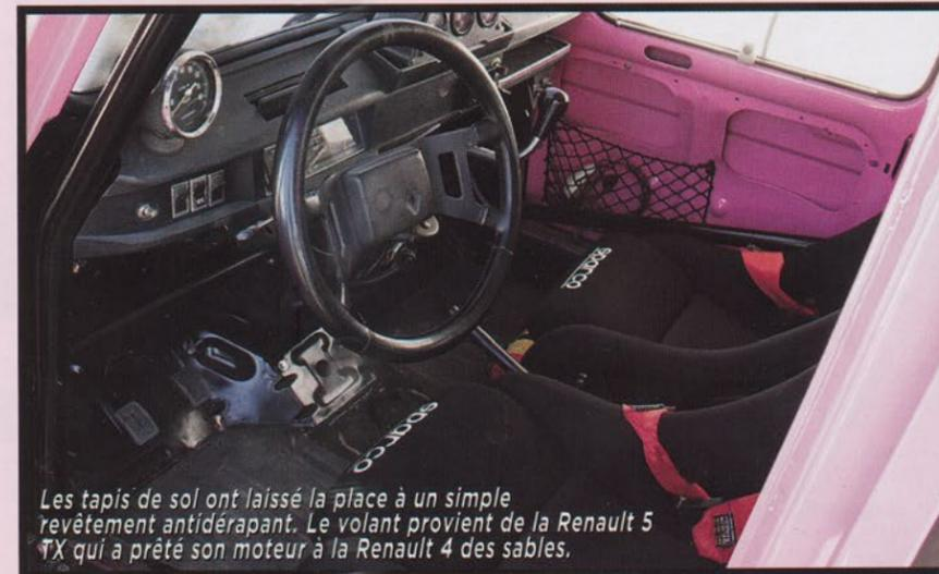
Les tapis de sol ont laissé la place à un simple revêtement antidérapant. Le volant provient de la Renault 5 TX qui a prêté son moteur à la Renault 4 des sables.
