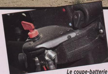
Le coupe-batterie installé sur la console de chauffage. Le lecteur de carte est le seul équipement électrique qui reste actif en cas de coupure générale. Malin !
