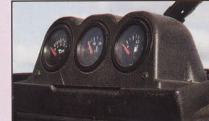
Pression d'huile, température d'eau, jauge de réservoir de carburant, bref, l'essentiel pour surveiller la mécanique d'un coup d'œil.
