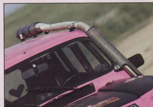
A hauteur du pare-brise, une plaque aérée antibrûlure a permis d'enfermer le tube d'échappement.
